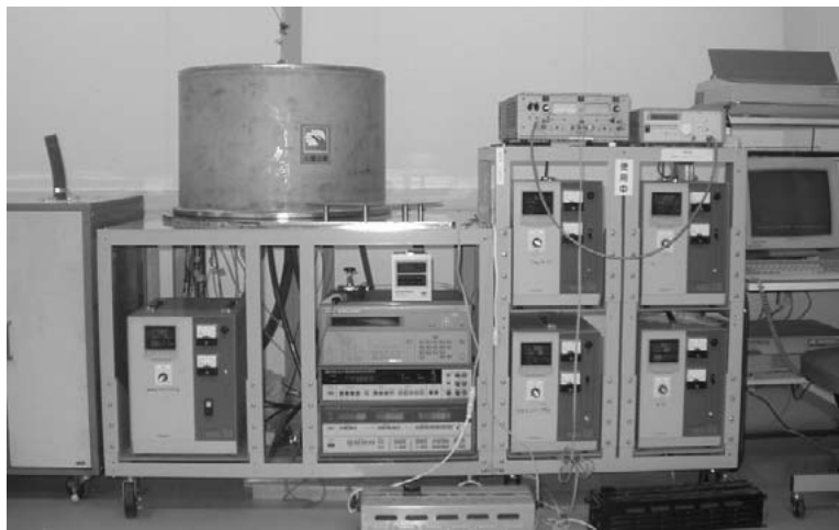
写真1 開発した熱伝導率測定装置
