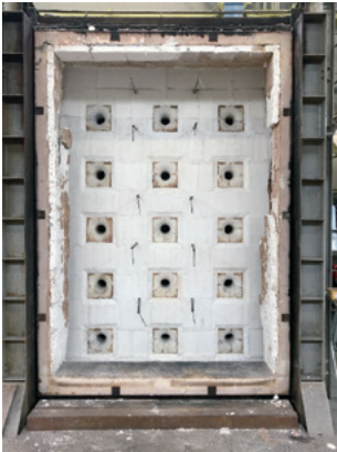
図2 壁用耐火試験炉外観
