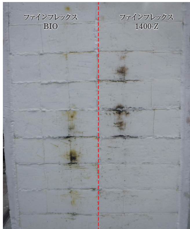
図4 1200℃×50hr加熱後外観 着色部は加熱により炉から付着した汚れである。
