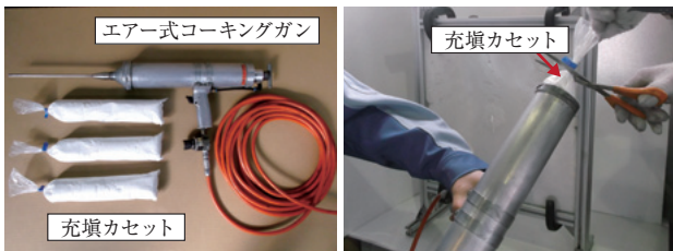
図3 エアース式コーキングガンとカートリッジの装填
