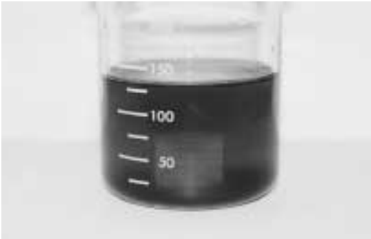
写真3 溶剤残存素子 漬後の洗浄液 ( 漬時間5分間)
