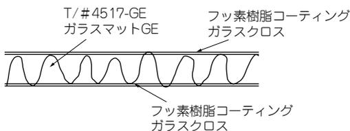
図1 エネサーモCRの断面構造
