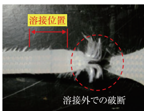
PFA溶接破断写真
