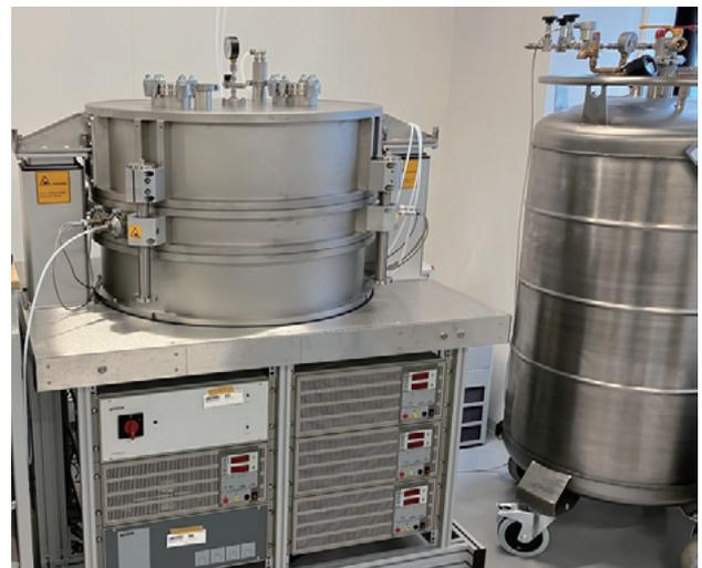
図2 低温GHP法装置の外観
