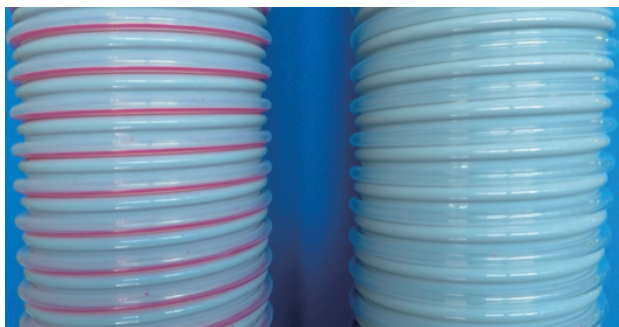
図13 廃液開始から5分後のチューブの様子(図12の中心部写真) 左:HGチューブ 右:UGチューブ
