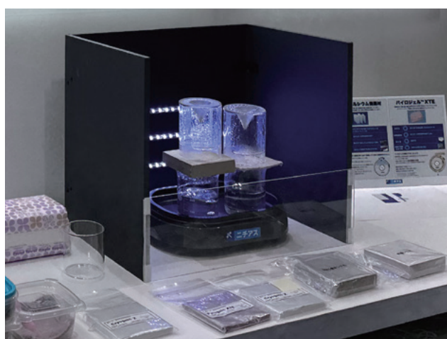
〈パイロジェル(右側)の水蒸気透過性・撥水性確認実験のデモンストレーション〉
