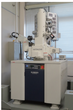
図5 FE-SEM/EDS (走査電子顕微鏡/エネルギー分散型X線分析)
