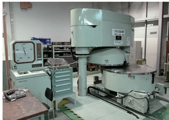
図12 10MN圧縮試験機 (載架台φ1600mm)
