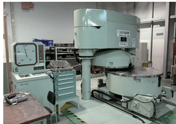
図12 10MN圧縮試験機（載架台φ1600mm）
