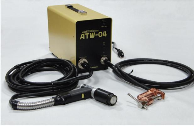
図4 溶接機（鉄骨-固定ピン溶接用）
