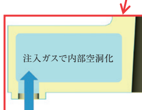
図9 厚肉部位拡大 注入ガスのイメージ
