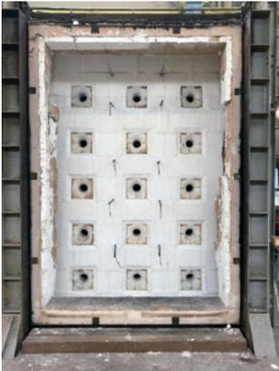
図2 壁用耐火試験炉外観
