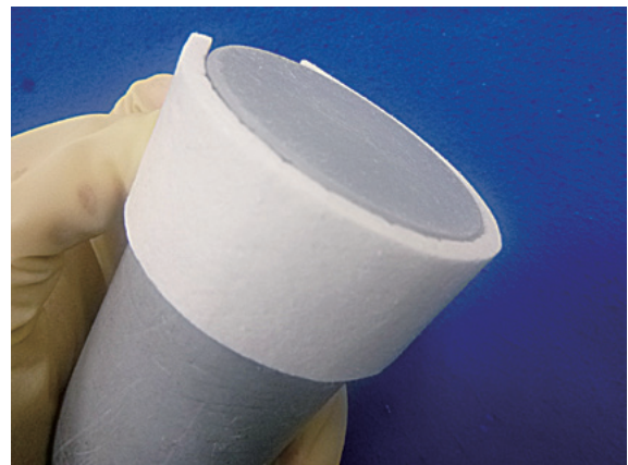
図3 TOMBO™ No.5635-R「ファインフレックス BIO® ペーパー R」3mm品のφ50mm管への巻きつけ
