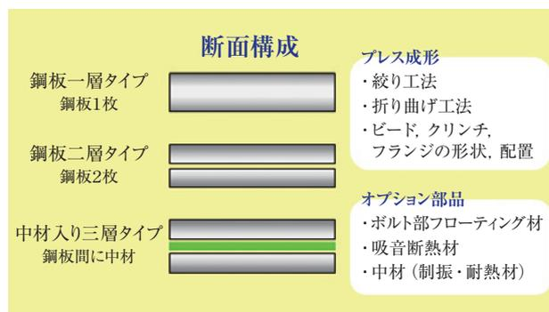
図2 「インサルカバー®」の一般構成
