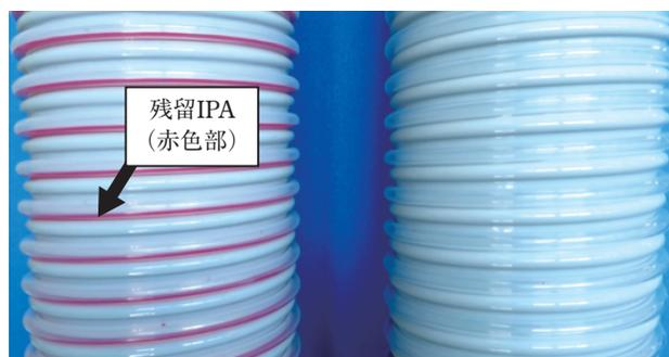
図6 液抜き開始から5分後のチューブの様子
