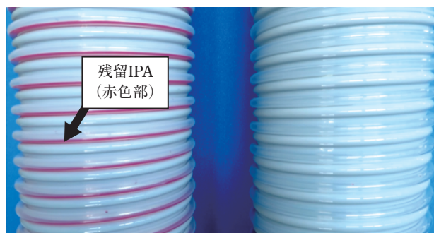
図6 液抜き開始から5分後のチューブの様子 左：HGチューブ 右：UGチューブ
