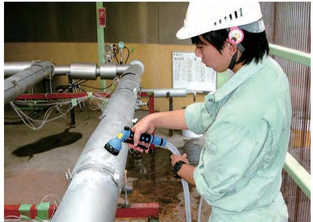
図4 保温材散水乾燥実験
