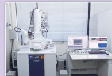
走査型電子顕微鏡-エネルギー分散型X線分析装置 (SEM-EDS)
