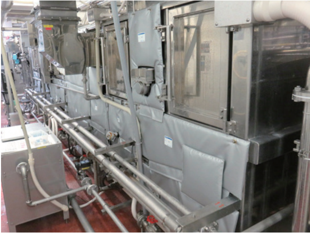
図7 食品製造装置A本体への取付例
