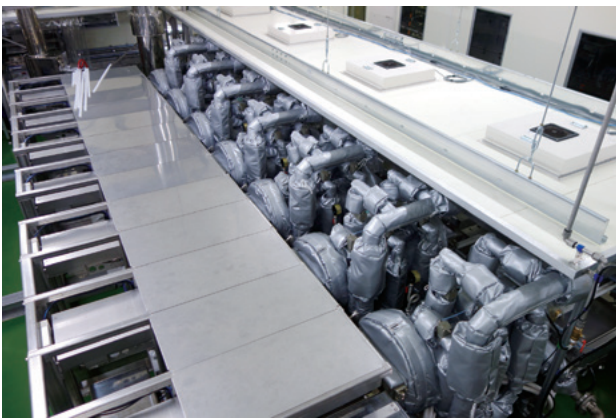
図8 食品製造装置B本体および配管部への取付例
