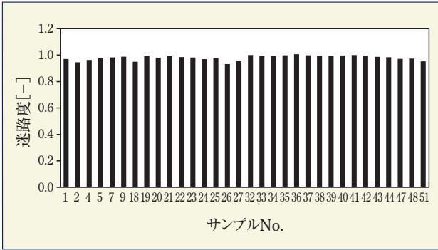
図3 n2法で求めた試験体の迷路度
