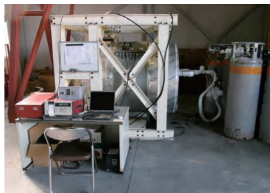
図22 「フォームナート サポート」の性能実証試験 (サポートの性能実証は配管を実使用温度まで冷却した状態で設計荷重を負荷して行っている)
