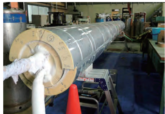
図17 「フォームナート カバー TN」のLNG温度における性能実証試験
