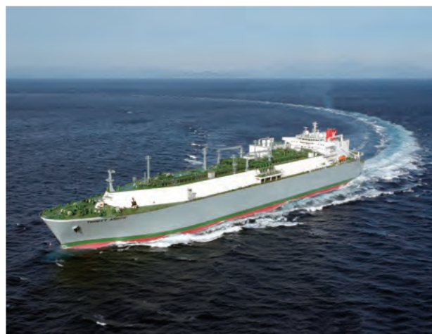
図11 今治造船株式会社殿建造のLNG船TRINITY ARROW (GTT Mark III型、貨物容量155千kL)
