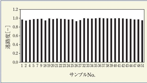
図3 n2法で求めた試験体の迷路度
