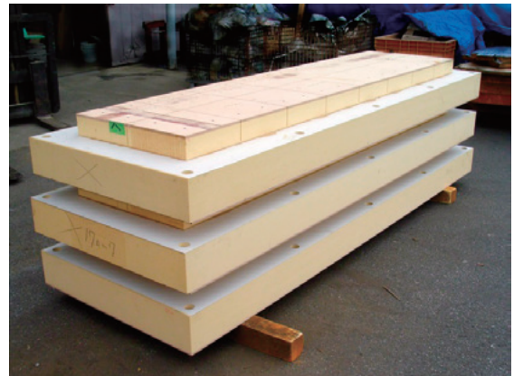
図14 ノンフロンR-PUFを用いたGTT Mark III型の防熱パネル
