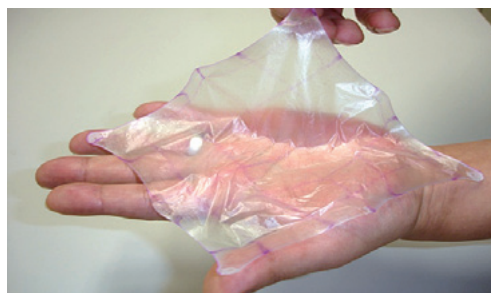
図2 本技術によって得られた高強度UHMW-PE膜 7) 。
