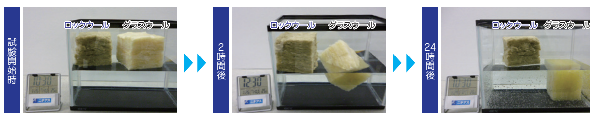
図9 ロックウールとグラスウールの耐水性の比較
