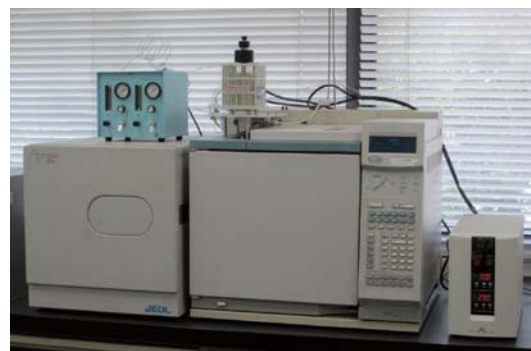
図4 熱分解GC/MS (熱分解ガスクロマトグラフ質量分析装置)
