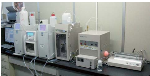
図8 燃焼IC (燃焼イオンクロマトグラフ)
