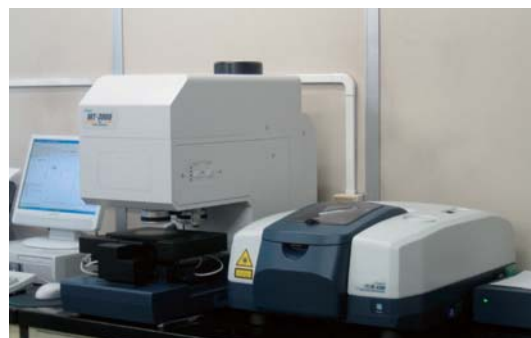
図3 顕微FT-IR (顕微付フーリエ変換赤外分光分析装置)
