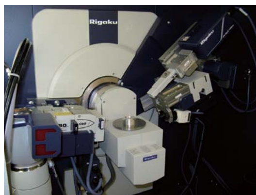
図2 XRD (X線回折装置)
