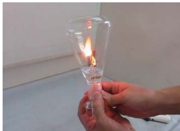
図1 燃焼フラスコ法による前処理の様子
