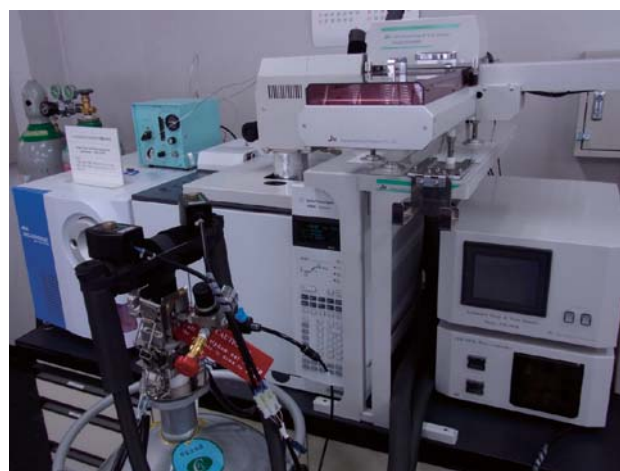
図6 P&T-GC/MS (パージ&トラップーガスクロマトグラフ質量分析装置)
