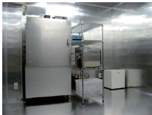
図7 ホルムアルデヒド捕集室（JIS A1901対応）
