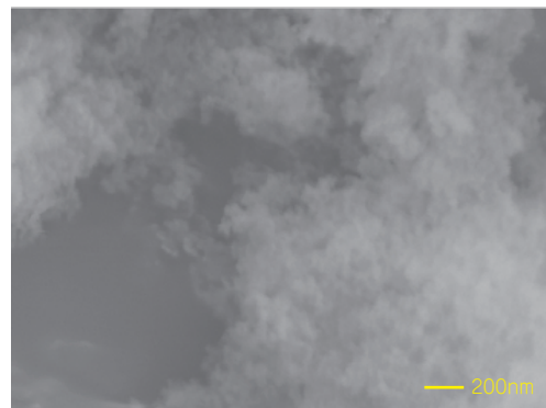
図6 シリカ成分添加成形体のSEM写真 ( 1200^\circ\text{C} \times 24\text{hr} 加熱後)
