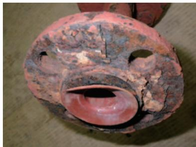
図14 フランジ部の腐食
