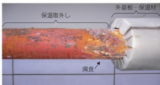
図1 屋外配管の外面腐食
