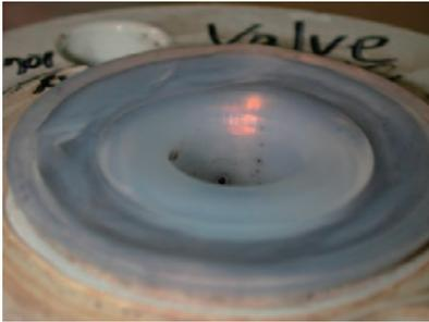
図17 フレア面の変形
