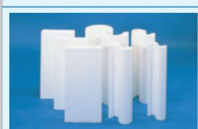
各種配管・ダクトに使用されるけい酸カルシウム保温材です。施工が容易で機械的強度が大きく耐水性に優れており、1000℃までの高耐熱性で高温部の断熱材として使用されます。
