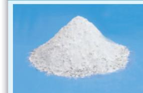
ボイラールーブリの耐火材や耐火レンガのバックアップ材として使用される不定形耐火材です。熱伝導率が低く熱損失が少なく、吹き付けなどの施工によりさまざまな形状に対応できます。
