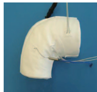
図1 プレノヒータ外観
