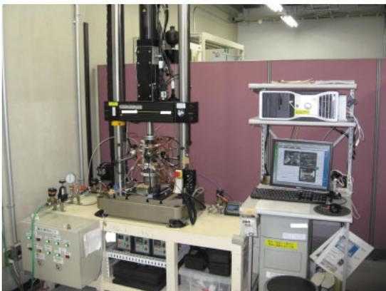
写真5 油圧疲労試験機
