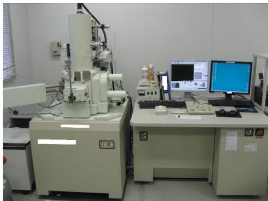
写真3 元素分析機能付フィールドエミッション型走査電子顕微鏡
