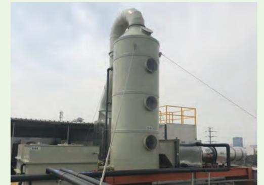
蘇州露佳斯工業製品有限公司の屋上に設置された除去処理装置
