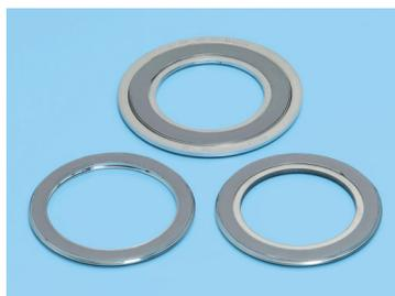
V字形をした金属製のフープと、フィラーと呼ばれるクッション材を交互に重ね、うず巻状に巻き付けたガスケットです。
