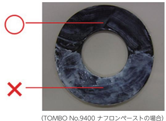
例として図2にTOMBO No.1120のペーストなしの場合とペーストありの場合の、常温での許容締付面圧を示します。ペーストありの場合は許容締付面圧が小さくなりますので、ペーストを使用する場合は、図3の「○」印で示すように薄く均一に塗布してください。図3の「×」印は塗りすぎです。
