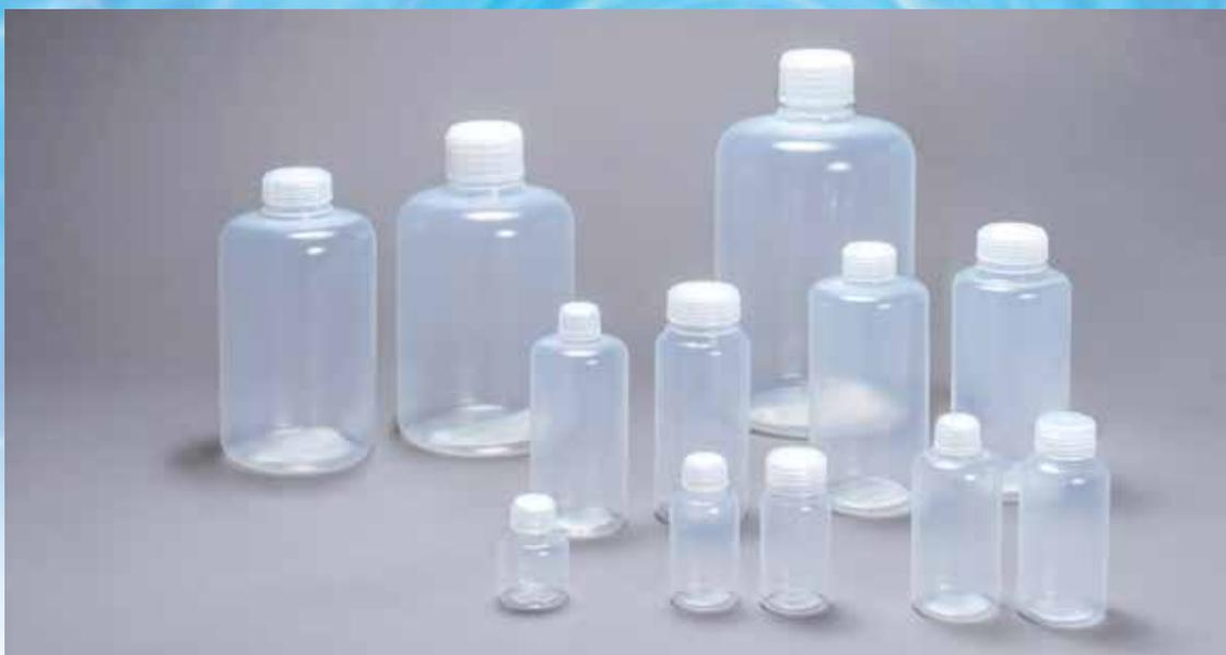
ナフロンPFA理化学容器は、ブロー成形法により成形したふっ素樹脂PFA製容器です。耐薬品性に優れ、かつ使用液体への不純物の溶出が極めて微量です。また、ガラス製に比べて、衝撃に強く、落としても割れにくい容器です。
