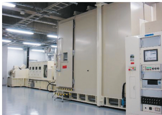
ブレーキ鳴きダイナモメーター Dynamo tester for brake noises
