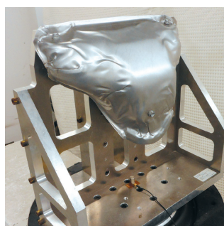
大型加振機による耐久試験 Durability test using a large-scale shaker
