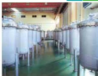
薬液を貯蔵するふっ素樹脂製タンクライニングです。薬液のクリーンを保ちます。
