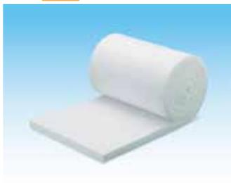
ボイラーの天井や炉壁などに使用されるアルカリアースシリケート(AES)ウールで構成された断熱材です。炉内の熱漏れを断ちます。
