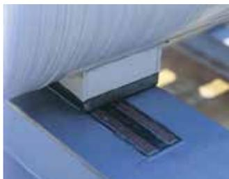
配管支持材と組合せ、配管の熱による伸縮に支持材を追従させるふっ素樹脂性のすべり部材です。
