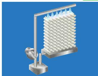
外気あるいはクリーンルームに存在する水溶性ガス(NO<sub>2</sub>、NO<sub>3</sub>、SO<sub>4</sub><sup>2-</sup>、NH<sub>4</sub><sup>+</sup>)を除去するシステムです。排出される空気をクリーンに保ちます。
