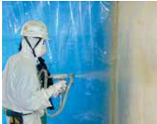
ロケットの燃料タンクの外部に吹きつけて使用される断熱材の原液です。極低温となる液体燃料を保冷します。
