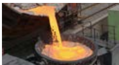
① 製鉄所から出た溶融スラグを溶さい鍋に移し、当社工場内へ搬入します。
