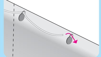
連結用固定ピンを用い、ワイヤーなどで連結することでピンの落下を防止できます。
