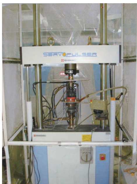
加熱面圧試験機 Hot Pressure tester (Up to 1000°C)
