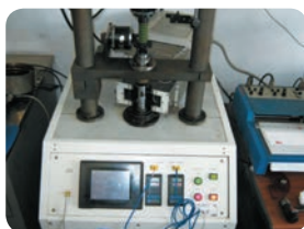
ジャーナル式摩擦摩耗試験機 Journal bearing friction and wear tester
